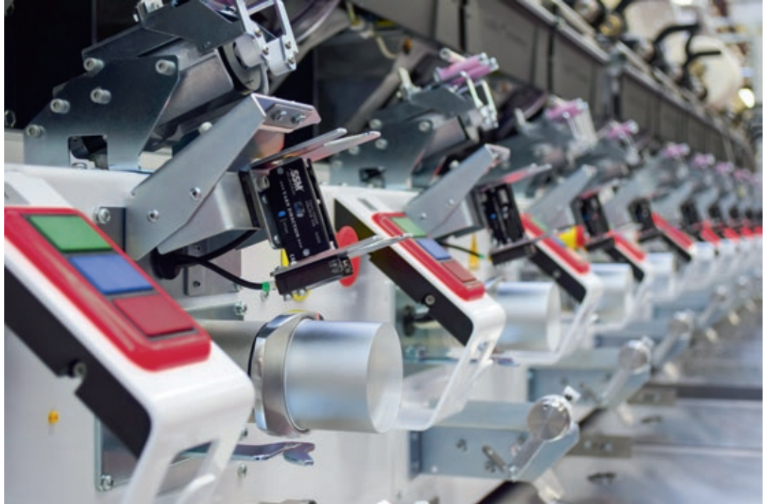
Die XENO-Präzisionsspulmaschine verarbeitet mit ihrer elektronischen Fadenverlegung alle Arten von Stapelfasern und Filamentgarnen.
