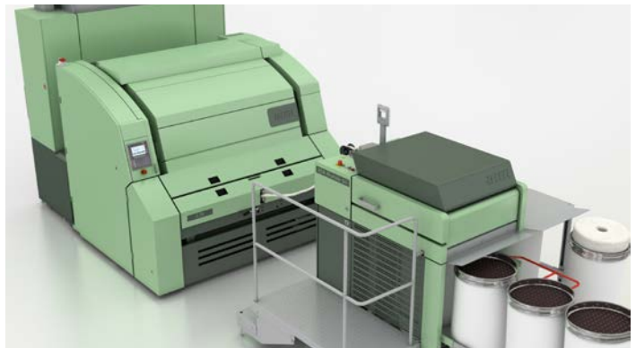
配置并条模块RSB-Module 50。梳棉机为转杯纺纱机提供理想的喂入棉条。
