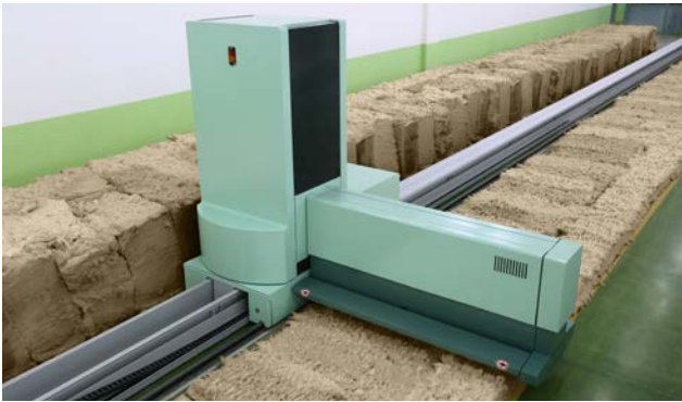
自动抓棉机UNIfloc A 12开松，抓取生产理想棉束
