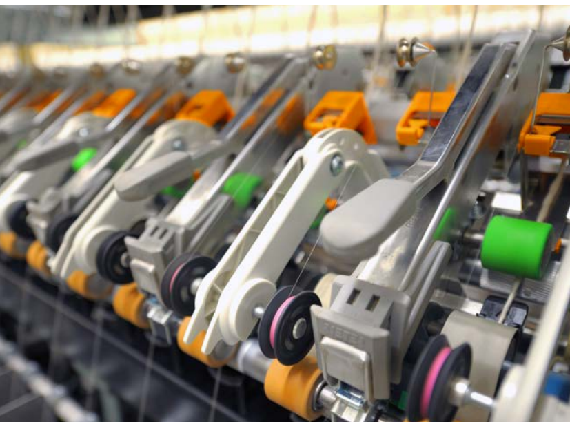
Abb. 2 Für alle Anwendungen die beste Lösung – Rieter-Ringspinnmaschine mit Coregarneinrichtung.
