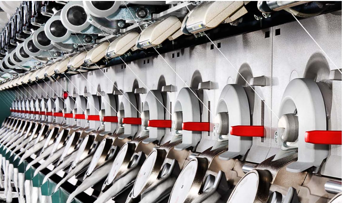
图1 R 66机器两端都配备了吸风，能最大程度地减少损耗并提高能效。
