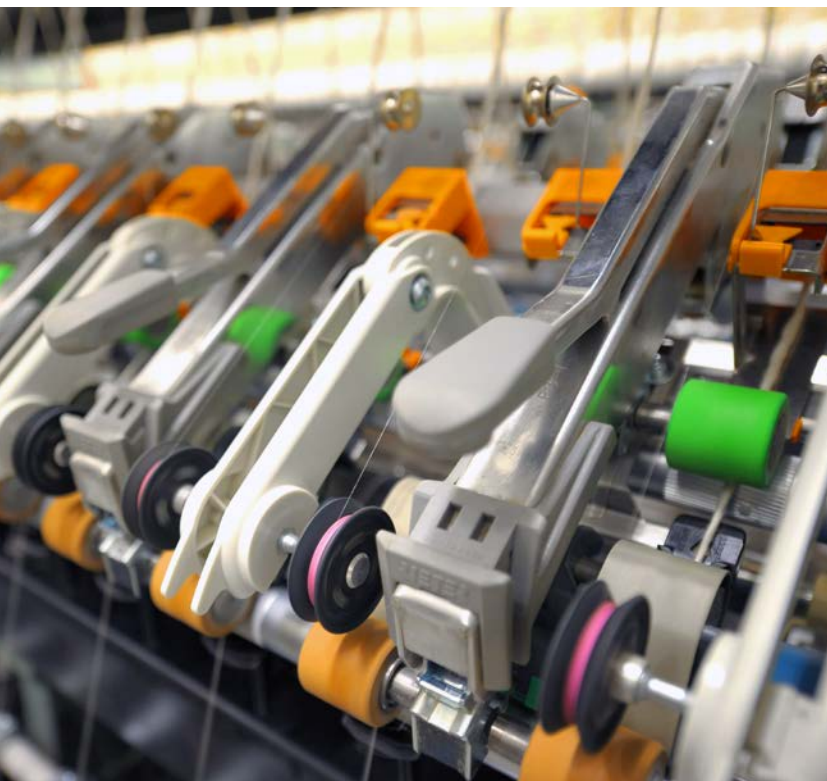
图2 适用于所有纤维的最佳解决方案 – 配备包芯纱装置的立达环锭细纱机。
