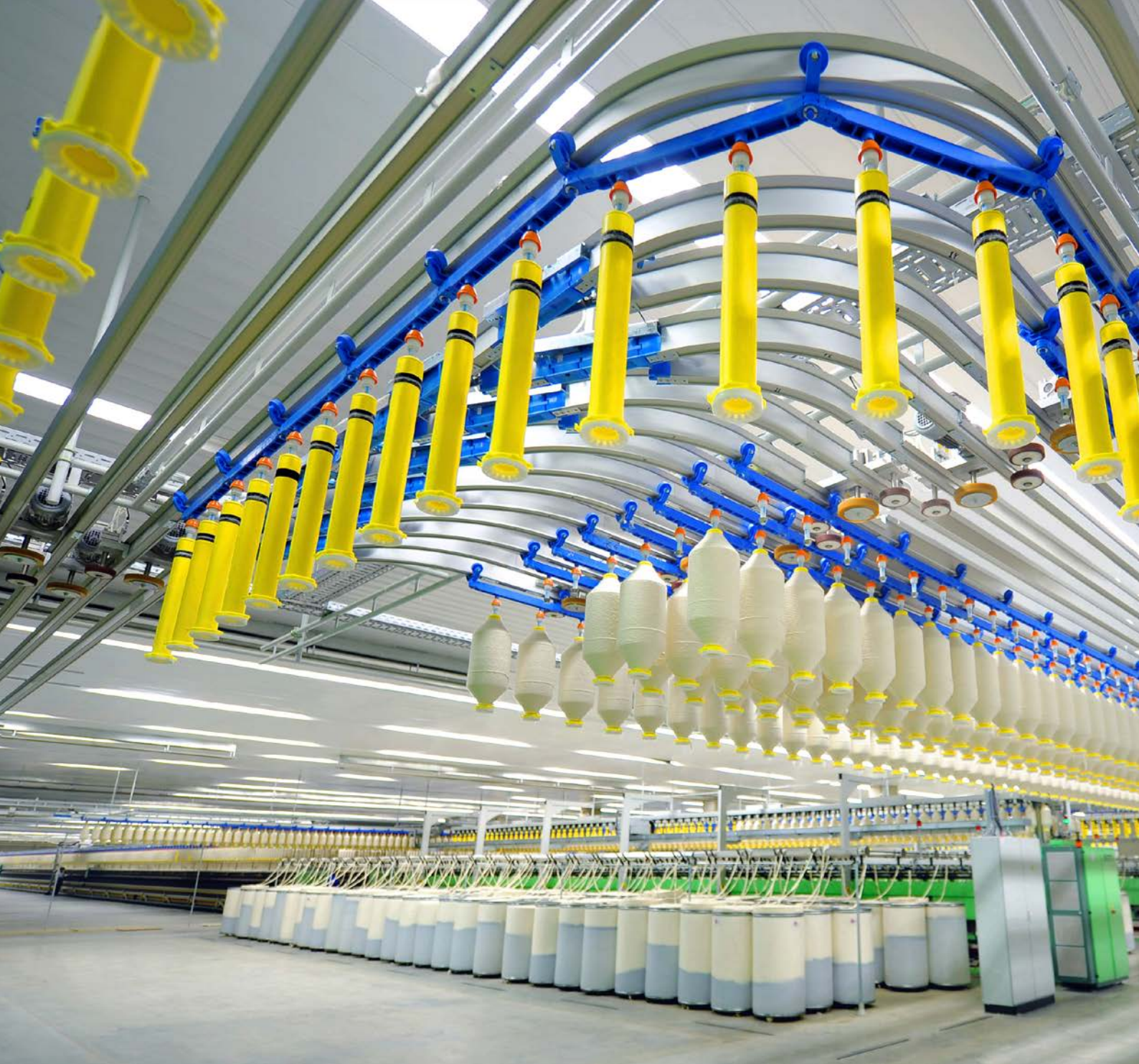
Şekil 1 SERVOrail fital bobini transport sistemi – kalite ve verimlilik bilincinde olan iplik işletme için.
