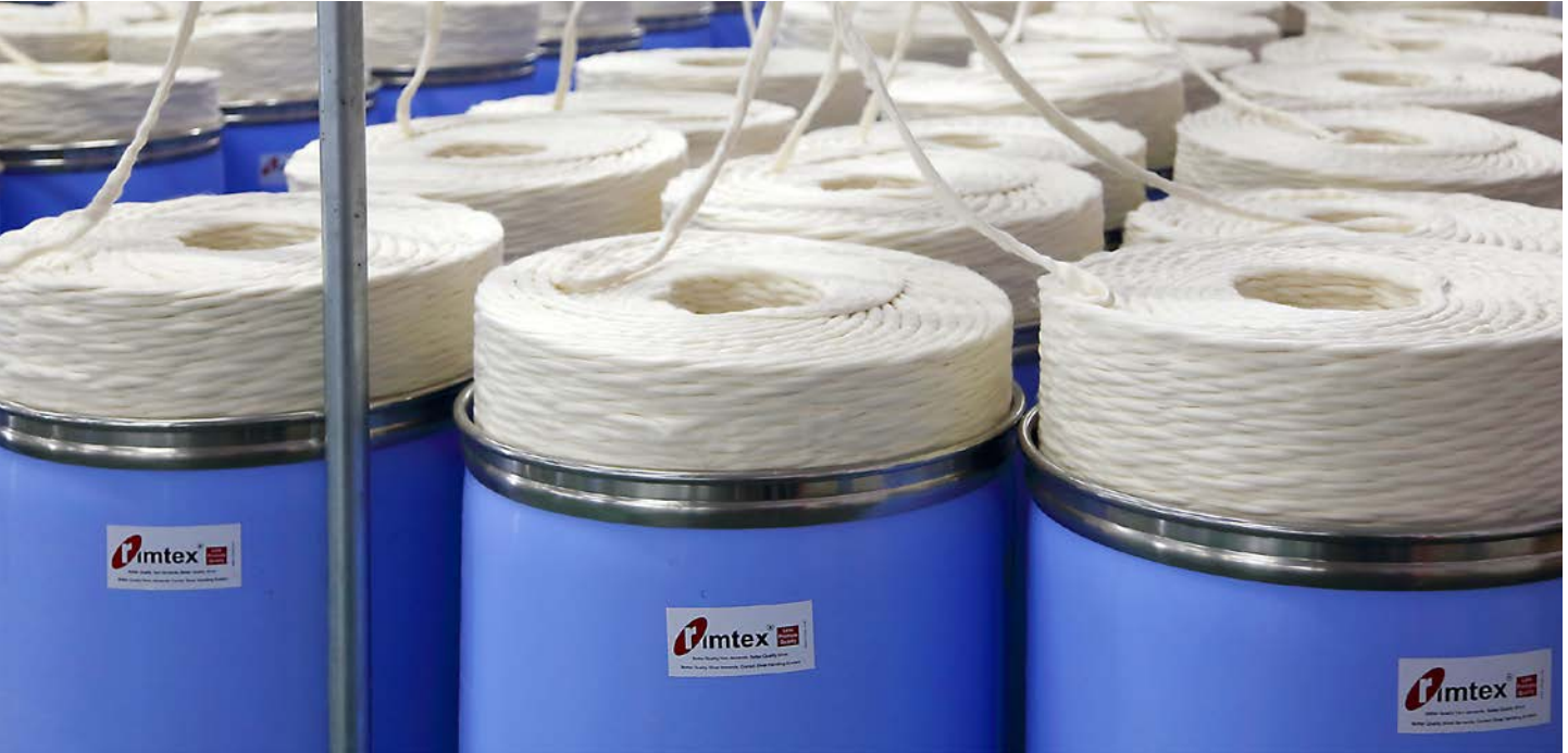
Şekil 1 Rimtex kovaları doğru şerit istifleme ve kusursuz şerit sağlanmasını garanti eder.
