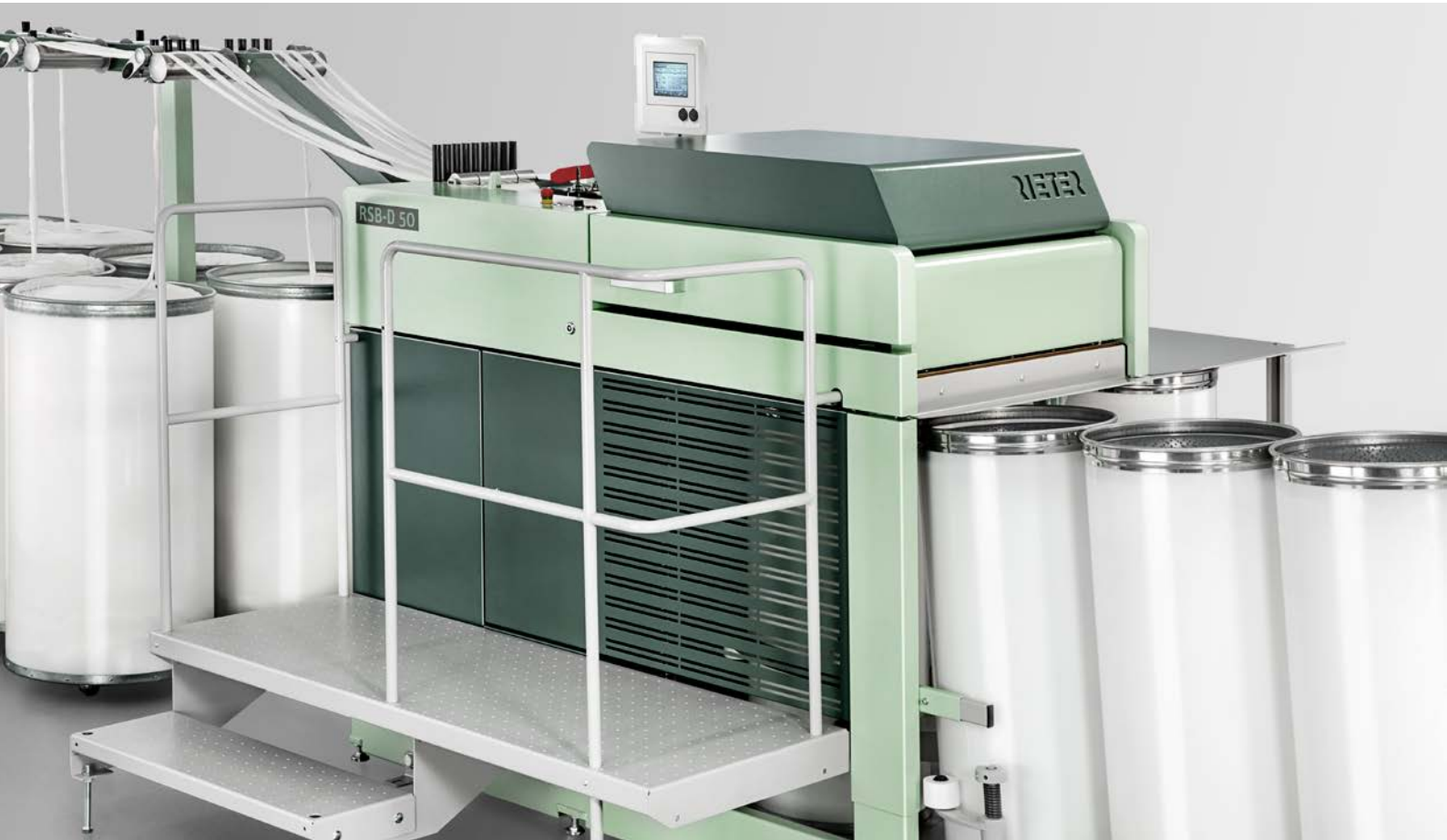
Şekil 1 RSB-D 50 Cer makinası 1 200 m/dak. kadar çok yüksek çıkış hızları ile en yüksek üretim.
