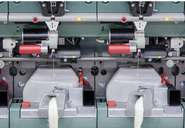
Şekil 2 Modernleştirilmiş S 36 eğirme kutusu daha yüksek iplik mukavemeti ve daha sık rastlanan hatayı garanti eder.
