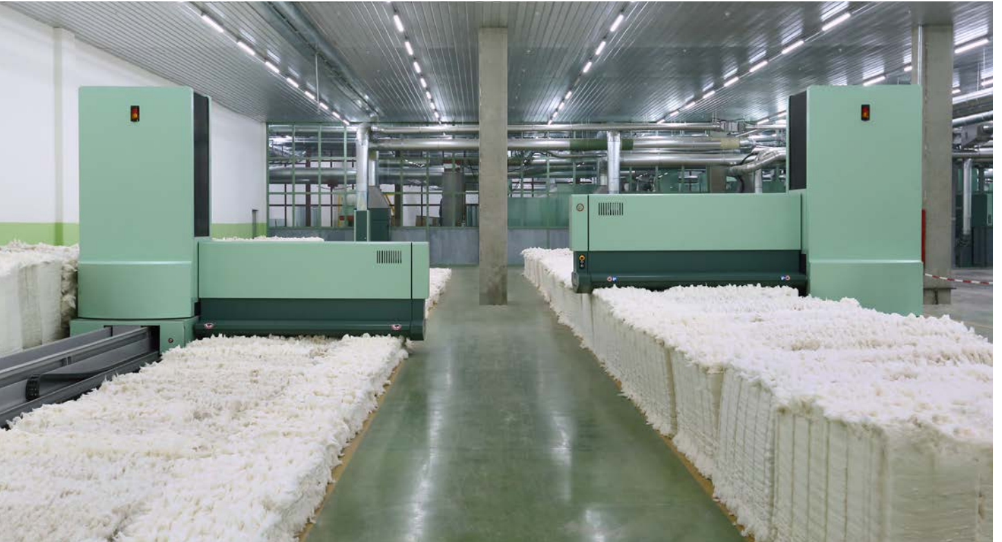
Şekil 1 UNIfloc A 12 – Balyaları açmanın modern ve etkili yöntemi.
