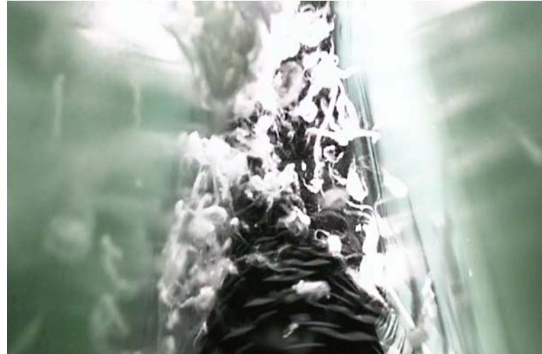
Şekil 3 Patentli Wobble diskli alıcı silindir sayesinde, tutamların zedelenmeden ve sürekli ekstraksiyonu.
