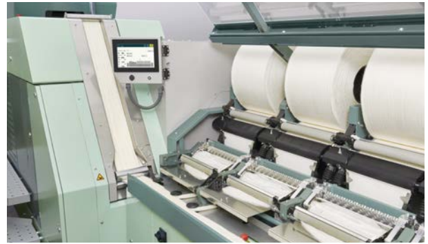
新款精梳机E 90集成SB-D 50并条技术，可达到最高的棉条质量。
