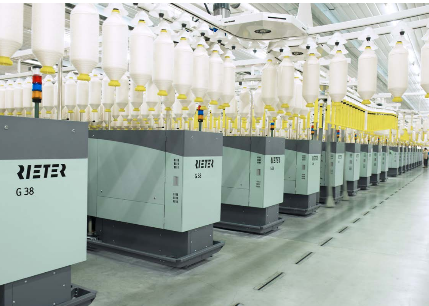
图1：经过验证的环锭细纱机G 38通过高速套件最高可将纱线产量提高15%。
