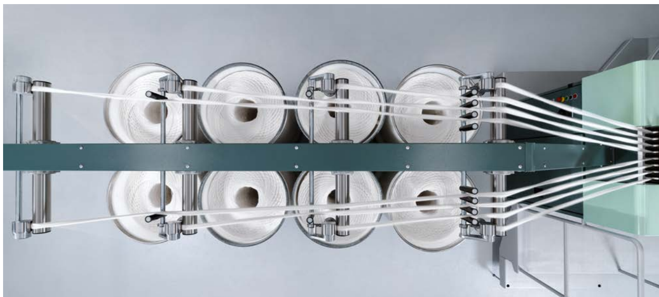
图2：增强的积极式导条架可增加耐用性
