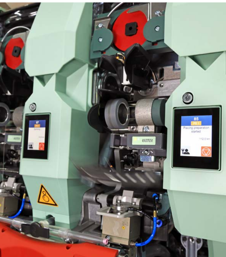
图4：简化操作 - 每个纺纱单元带有一个显示器
