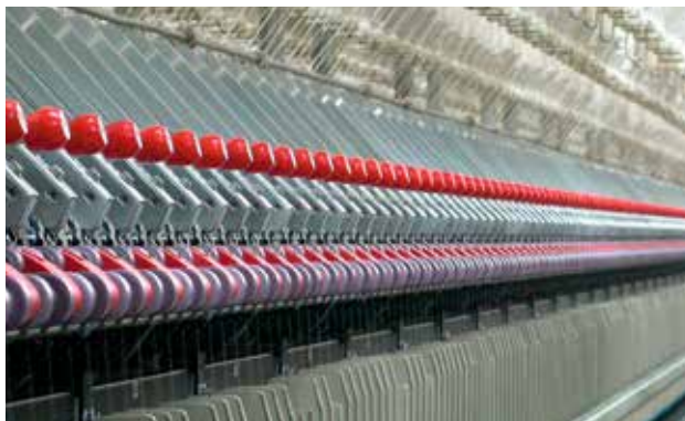
Lakshmi LR6 细纱机，配备绪森EliTe®倚丽特紧密纺设备以及HP摇架
