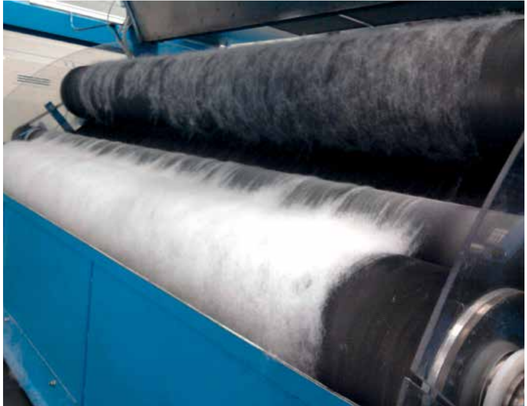
纤维与Hipro 针布之间粘附状况。下工作辊配备Hipro针布，上工作辊配备标准金属针布。
