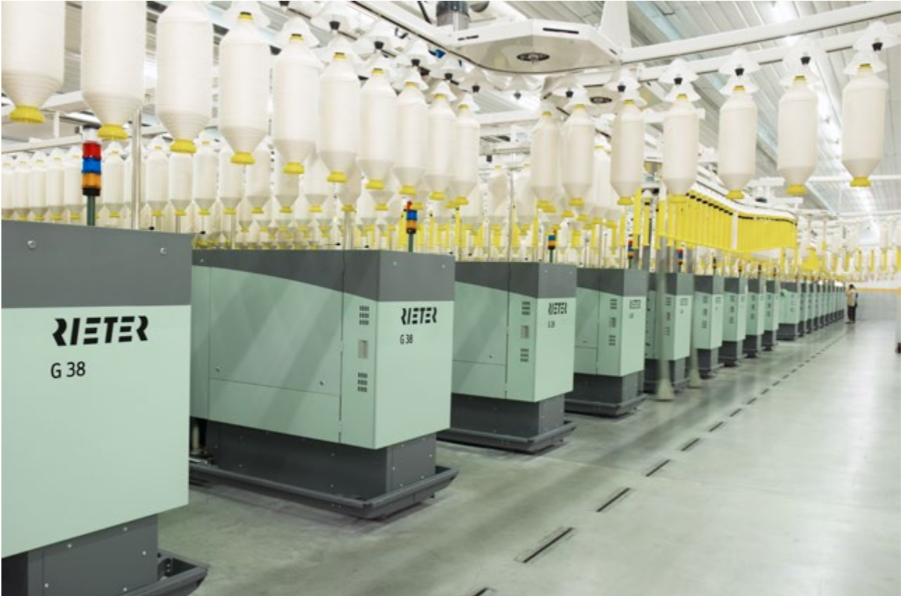
Şek. 11: Ring iplik makinası G 38, çift taraflı emme ve enerji tasarruflu komponentler sayesinde minimum enerji kullanmaktadır.
