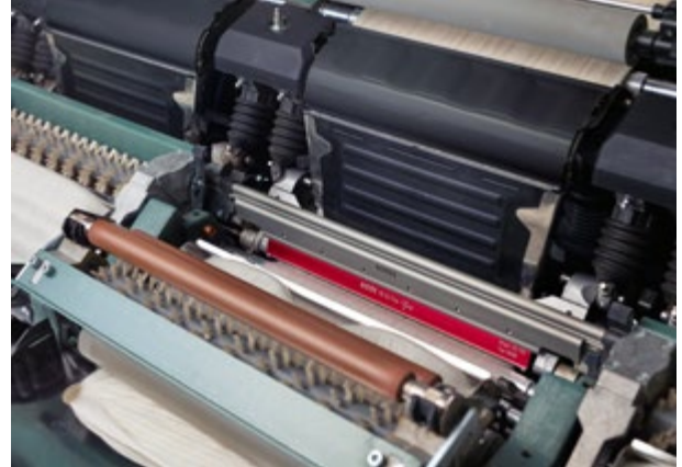
Şek. 6: Penye makinası E 90, en iyi ham madde kullanımına yol açan zedelemeyen ve kontrollü elyaf işleme sağlamaktadır.
