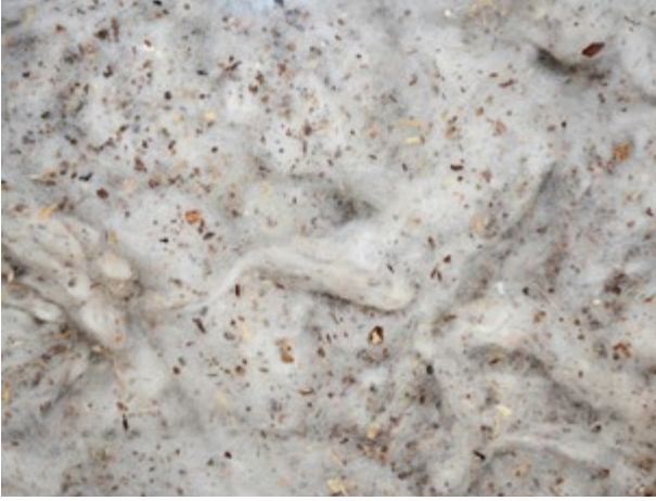
Şek. 5: Telefi veya yüksek kısa elyaf içeriği bulunan materyali eğirirken "direkt" open end iplikçilik prosesi optimum çözümdür.
